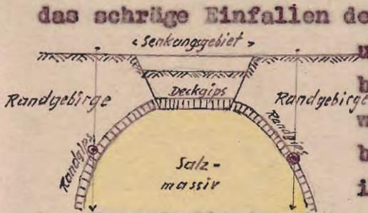
das schräge Einfallen des Hauptsalzmassivs in großer Tiefe mit dem unvermeidbaren natürlichen Substanzverlust bei  $\odot$  der beistehenden Skizze zurückgeführt worden sind. Diese Frage ganz präzise zu beantworten, ist erst dann möglich, wenn es in irgend einem konkreten Falle darauf ankommt, unbedingte Sicherheit haben zu wollen. Im Augenblick liegt ein solcher Fall aber nicht vor und wer weiß wann? Bis dahin können solche kostspielige tiefe Kernbohrungen ruhig zurückgestellt werden.
